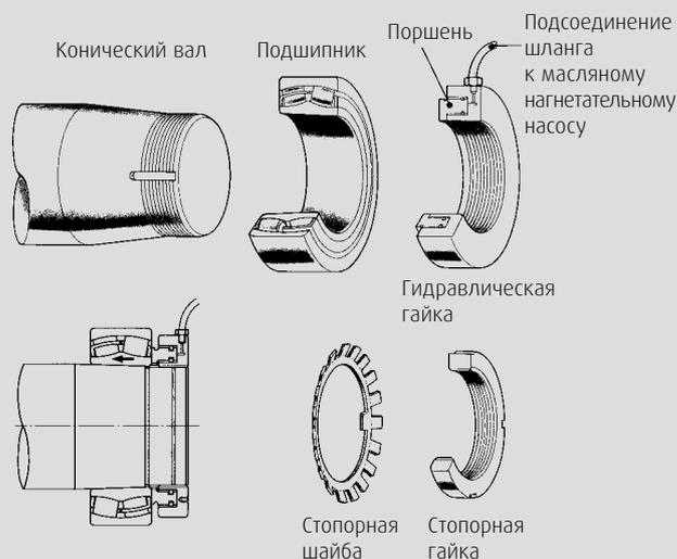
Рис. 6.26 Способ применения гидравлической гайки
