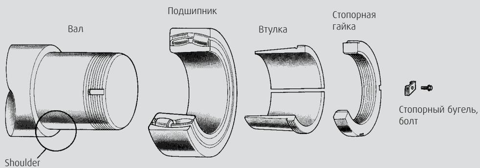
Рис. 6.16 Способ стопорной гайки
