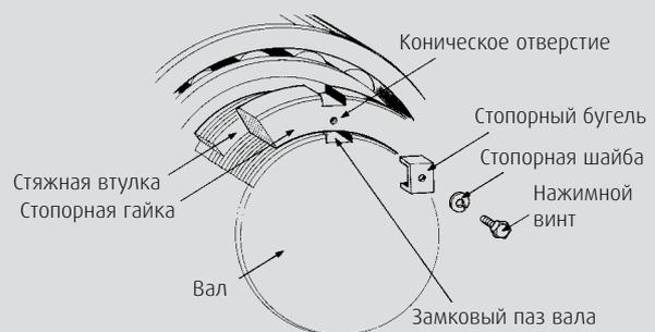
**Рис. 2.12** Установка стопорной шайбы по окончании регулировки зазора
