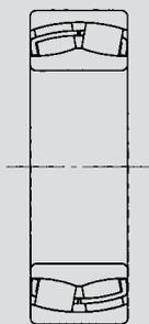
Рис. 1.3 Цилиндрическое внутреннее отверстие
