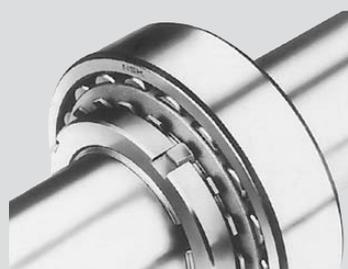
Рис. 2.7 Загибание усов стопорной шайбы
