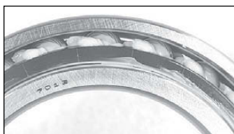
Rys. 1: Metoda smarowania łożyska kulkowego skośnego
