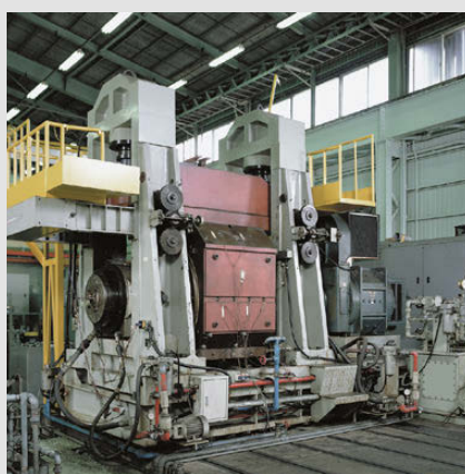
Banco prova per il collaudo di cuscinetti impiegati nei rulli di appoggio dei laminatoi
