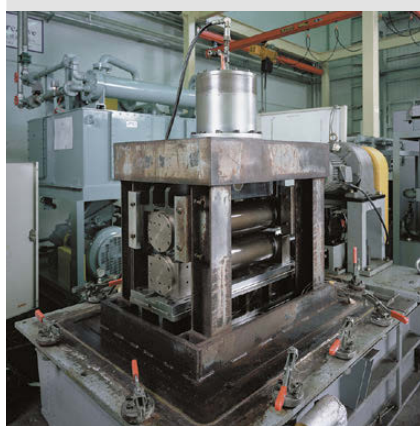
Banco prova per il collaudo di cuscinetti impiegati nei rulli motorizzati degli impianti di colata continua
