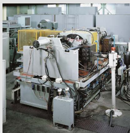
Banco prova per il collaudo di cuscinetti impiegati nei rulli di lavoro dei laminatoi
