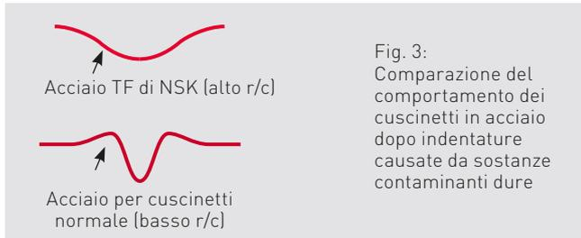
Fig. 3: Comparazione del comportamento dei cuscinetti in acciaio dopo indentature causate da sostanze contaminanti dure
