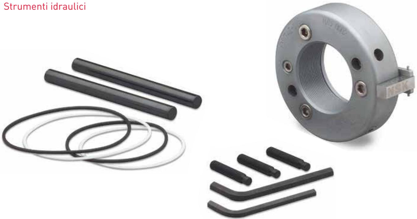
Le ghiera idrauliche di NSK applicano la forza con un processo di avanzamento assiale che consente un'installazione precisa e rapida dei cuscinetti con foro conico. L'avanzamento assiale garantisce la correttezza del gioco interno e degli accoppiamenti con interferenza monitorando il movimento del pistone, e quindi dell'anello interno del cuscinetto, rispetto alla ghiera idraulica. Questo metodo evita di dover continuamente verificare la riduzione del gioco mediante spessimetri.
