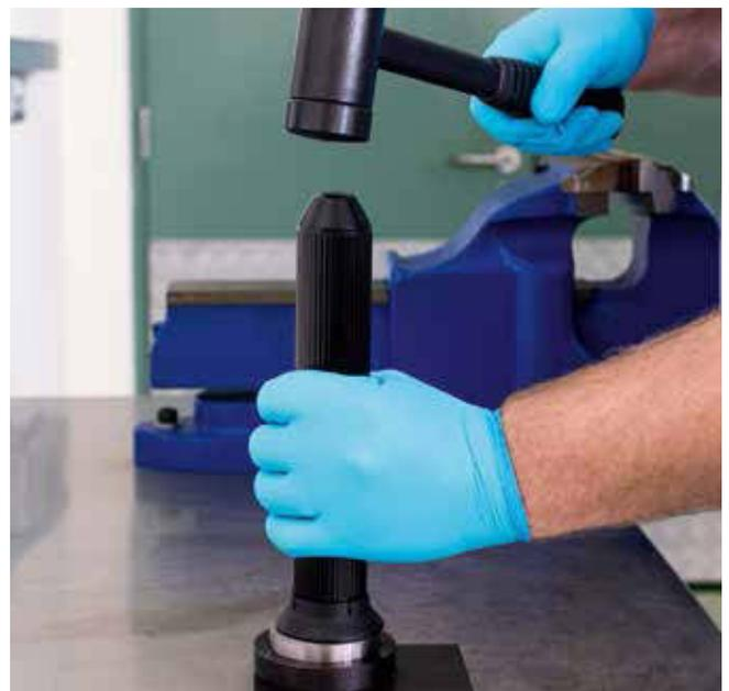
Per ovviare a questi problemi, NSK offre una gamma completa di strumenti che consentono di montare e smontare il cuscinetto senza danni. A questi si aggiungono i corsi di formazione di NSK che insegnano a utilizzare al meglio gli utensili e aiutano i tecnici a sviluppare procedure di montaggio sicure ed efficienti.
