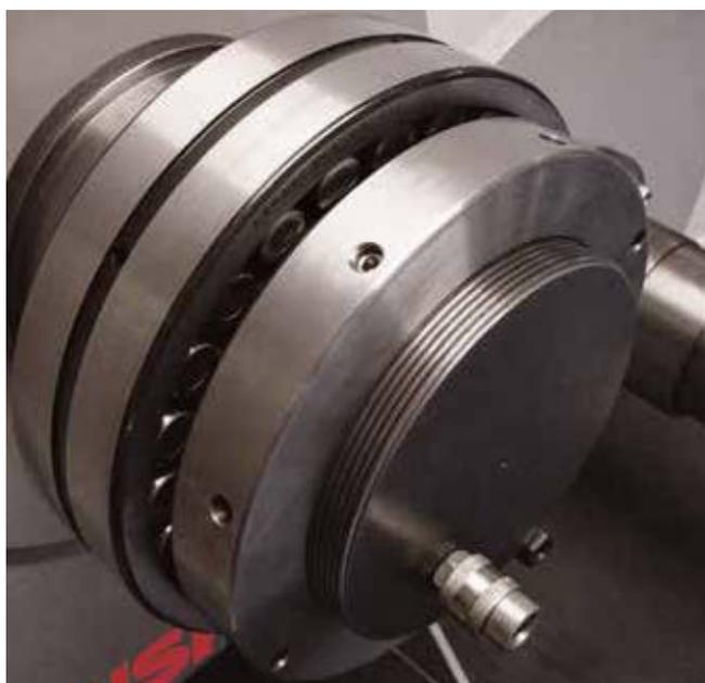
strumenti di NSK per il montaggio dei cuscinetti prevengono possibili danni e garantiscono l'applicazione di tutti i carichi sull'anello del cuscinetto che deve essere montato.
