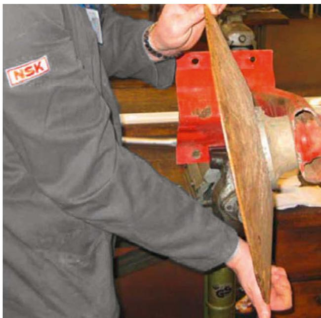
Un addetto di NSK rimuove l'unità Agri Disc Hub dal braccio della macchina
