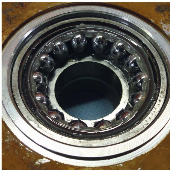
A seguito dello smontaggio dell'Unità, non è stata rilevata alcuna presenza di contaminazione nel cuscinetto o nel lubrificante
