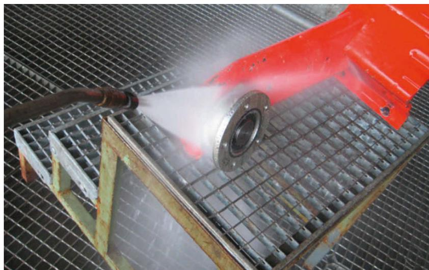
Al termine della prova non sono stati rilevati segni di infiltrazione dell'acqua nella tenuta a cassetta.
