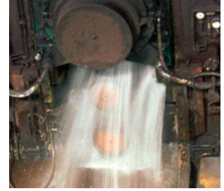
Condition de fonctionnement des roulements de cylindres de travail
