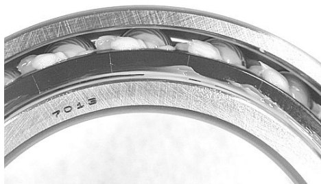
Fig.1.20 Graissage d'un Roulement à Rouleaux Cylindriques
