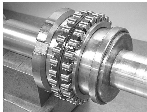
Fig. 1.13 Mise en place du calibre GN
