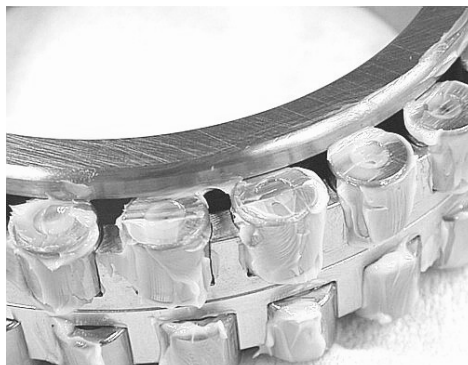
Fig.1.20 Graissage d'un Roulement à Rouleaux Cylindriques
