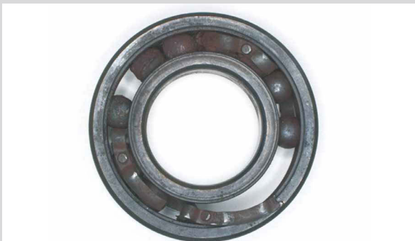
Photo 5 Pièce : Intérieur d'un roulement à billes à gorges profondes Symptôme : Cage endommagée, graisse épuisée, carbonisation Cause : Lubrification insuffisante
