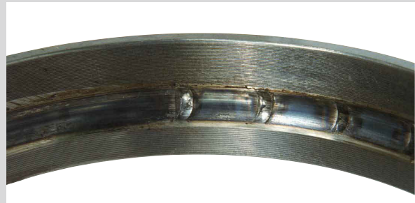
Photo 2 Pièce : Bague intérieure d'un roulement à contact oblique Symptôme : Décoloration de la piste, fusion à l'intervalle des billes Cause : Précharge excessive
