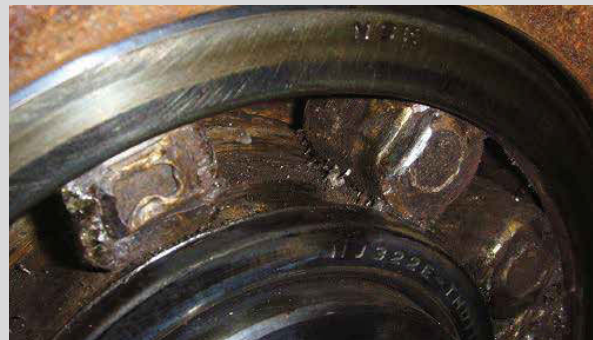
Photo 6 Pièce : Roulement à rouleaux cylindriques Symptôme : Grippage d'un rouleau à la surface de la piste du roulement de la bague Cause : Un jeu interne insuffisant a provoqué un échauffement causé par le mouvement de la bague intérieure et des rouleaux dans des conditions de vitesse élevée et de faible charge
