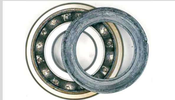
Photo 4 Pièce : Intérieur d'un roulement à billes à gorges profondes Symptôme : Graisse presque épuisée, carbonisation Cause : Lubrification insuffisante
