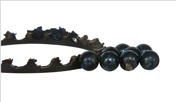
Photo 3 Pièce : Billes et cage de la Photo 1 Symptôme : Cage endommagée par fusion, billes décolorées et recouvertes de matière fondue Cause : Précharge excessive
