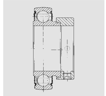
**Roulements rigides à billes avec bague de serrage**
