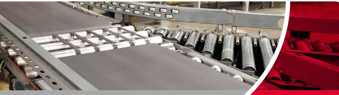
Les galets correspondent à des roulements à double rangée de billes à contact oblique dotés d'une bague extérieure renforcée. Celle-ci peut se présenter sous la forme cylindrique ou sphérique. La bague intérieure de ces roulements contient des trous de lubrification.
