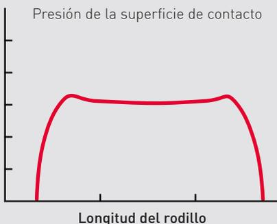
Carga pesada con desalineación
