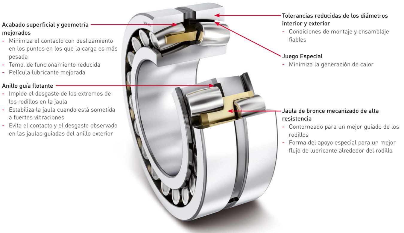
Las especificaciones VS3 y VS4 de NSK estabilizan la distribución de la carga controlando el juego interno y la tolerancia dimensional del rodamiento. La tolerancia dimensional del rodamiento se establece en 1/2 en
