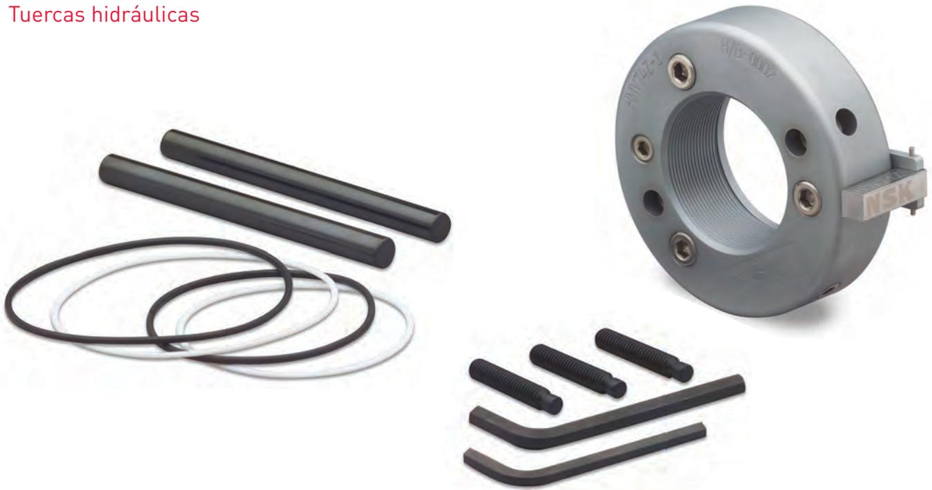
Las tuercas hidráulicas NSK utilizan un método de empuje axial para asegurar la correcta y rápida instalación de rodamientos con anillo interior cónico. El método de empuje axial asegura que los ajustes de interferencia y el juego interno sean correctos gracias a la supervisión del movimiento del pistón, y por lo tanto el anillo interior del rodamiento, en relación con la tuerca hidráulica. Este método reduce al mínimo la necesidad de comprobar constantemente la reducción del juego con galgas.
