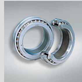
Zweireihige Axial-Schrägkugellager NSKTAC-D-Serie 6Druckwinkel 60°, sehr große axiale Steifigkeit
