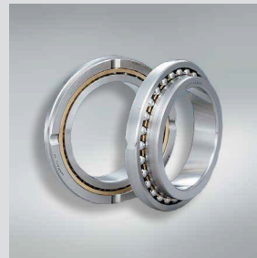
Zweireihige Axial-Schrägkugellager NSKTAC-F-Serie 50°-Druckwinkel mit höherer axialer Steifigkeit.
