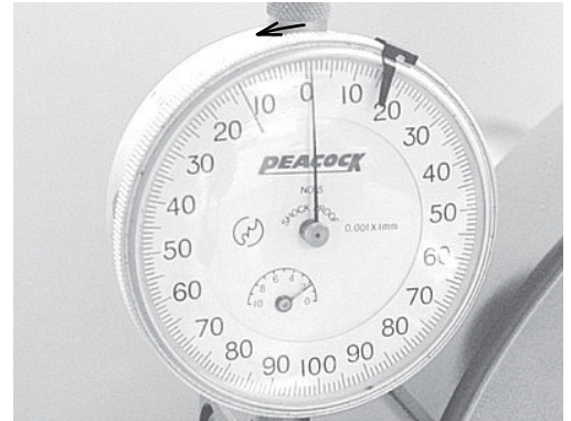
Abb. 1.11 Einstellen des GN-Hüllkreismessgeräts
