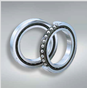
Hochgeschwindigkeits-Axial-Schrägkugellager BAR10-Serie Druckwinkel 30°, Eignung für höhere Drehzahlen. Austauschbar mit Lagern der Serien BTR und TAC
