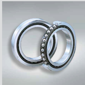
Hochgeschwindigkeits-Axial-Schrägkugellager BTR10-Serie Druckwinkel 40°, hohe axiale Steifigkeit, geringe Eigenerwärmung. Austauschbar mit Lagern der Serie TAC
