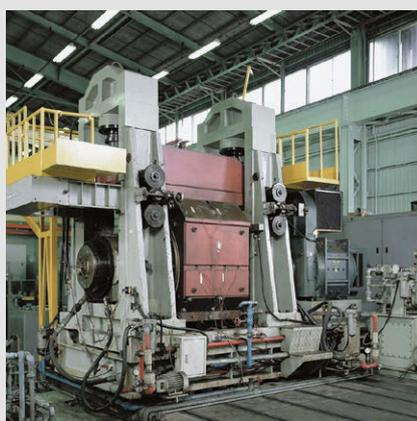
Prüfstand für die Wälzlager von Sützwälzen
