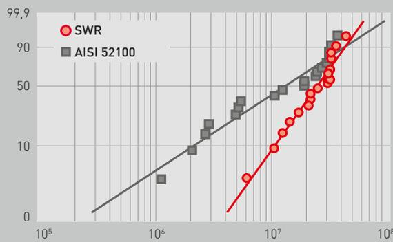
Auswertung der Betriebslebensdauer mittels Axiallebensdauerprüfung
