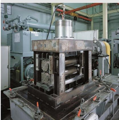
Prüfstand für die Wälzlager einer Strangführungsrolle
