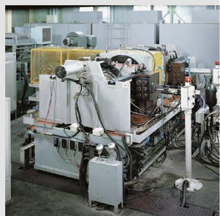
Prüfstand für die Wälzlager von Arbeitswalzen
