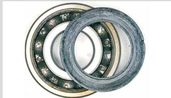
Foto 4 Bauteil: Innenleben eines Rillenkugellagers Symptom: Schmierfett nahezu erschöpft, Verkokung Ursache: Mangelschmierung
