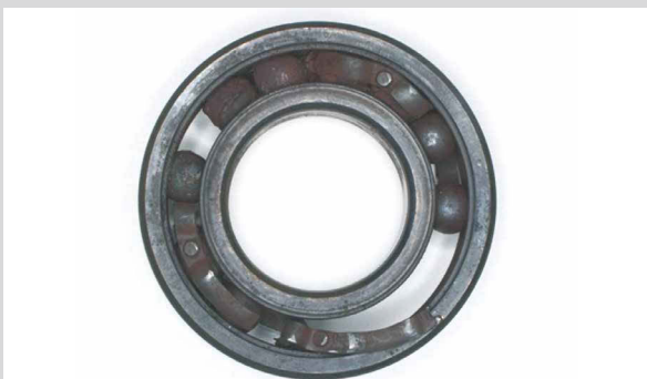
Foto 5 Bauteil: Innenleben eines Rillenkugellagers Symptom: Käfig beschädigt, Schmierfett erschöpft, Verkokung Ursache: Mangelschmierung
