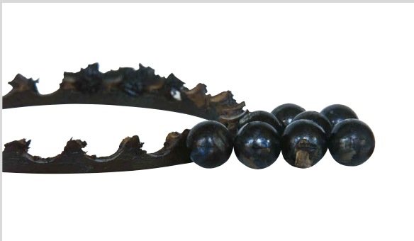
Foto 3 Bauteil: Kugeln und Käfig von Foto 1 Symptom: Käfig teilweise geschmolzen, Kugeln verfärbt und teilweise durch Schmelzrückstände bedeckt Ursache: Zu große Vorspannung
