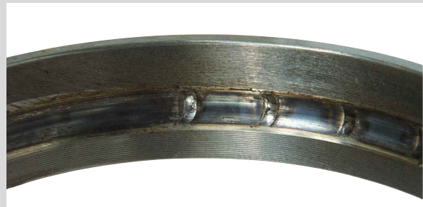
Foto 2 Bauteil: Außenring des Lagers aus Foto 1 Symptom: Verfärbung der Laufbahn, Verschmelzung im Wälzkörperabstand Ursache: Zu große Vorspannung
