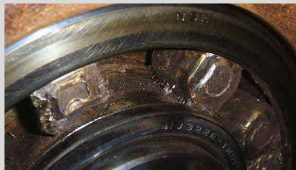
Foto 6 Bauteil: Zylinderrollenlager Symptom: Blockade der Rollen auf den Laufbahnen Ursache: Infolge einer zu geringen Lagerluft wurde durch die Bewegungen von Innenring und Rollen bei hoher Drehzahl Hitze erzeugt
