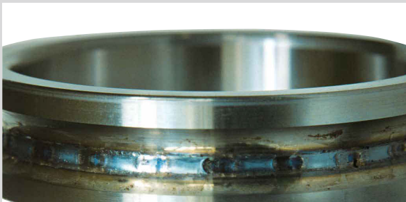
Foto 1 Bauteil: Innenring eines Schrägkugellagers Symptom: Verfärbung der Laufbahn, Verschmelzung im Wälzkörperabstand Ursache: Zu große Vorspannung
