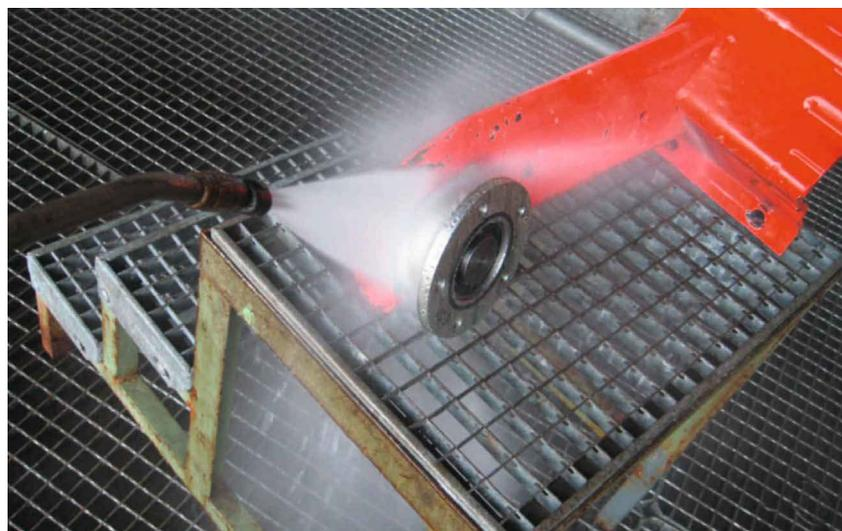
Nach Beendigung des Tests konnte kein Eindringen von Wasser durch die Kassettendichtung festgestellt werden.
