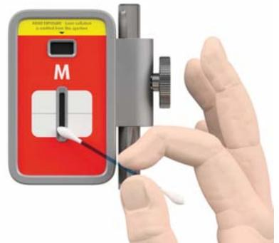
Para conseguir un funcionamiento óptimo, las aberturas del diodo láser y las superficies de los detectores deben mantenerse limpias de grasa o suciedad. La unidad de pantalla debe mantenerse limpia y la superficie de la pantalla protegida de arañazos.
