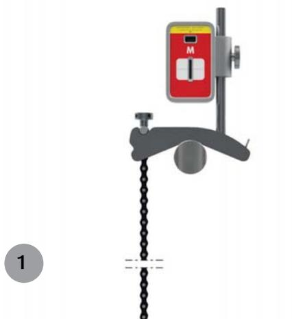
Mantenga la abrazadera en V en posición vertical y colóquela sobre los ejes objeto de medición.
