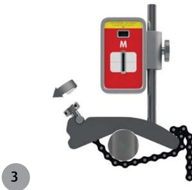
Apriete firmemente la cadena con el tornillo tensor. Si es necesario, utilice la herramienta de tensión suministrada. No apriete en exceso. Si el diámetro del eje es demasiado grande las cadenas se pueden ampliar con las cadenas de extensión.
